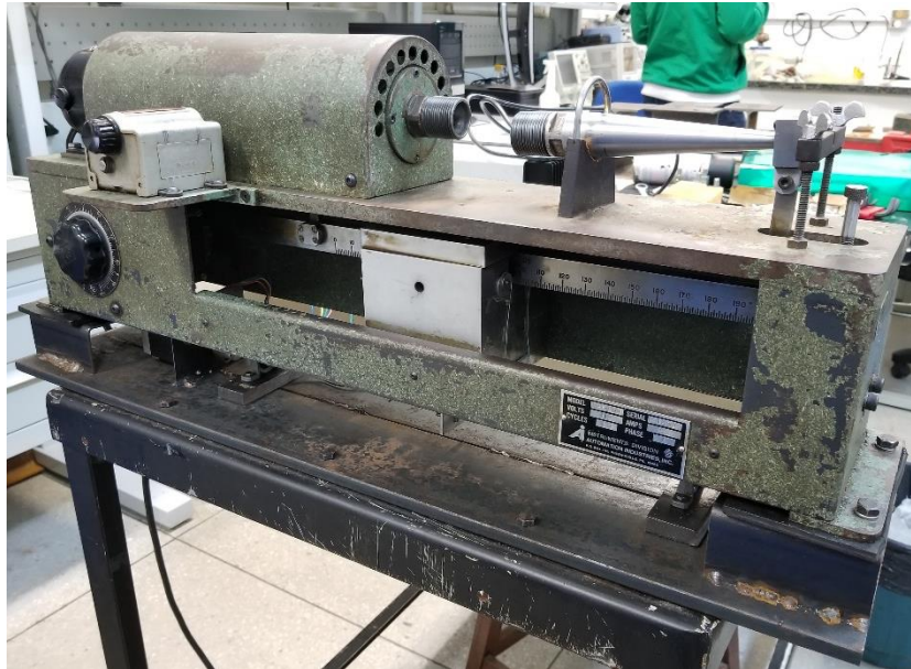
Figura 30: Montagem da máquina RBF-200 no sistema de adaptação. Fonte: elaborada pelo autor (2018).
